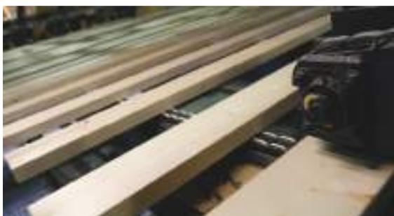
La selezione dei segati avviene con controllo visivo direttamente dopo il taglio, su efficienti impianti di selezione, ad opera di personale addetto al controllo che viene continuamente formato e che è supportato da una moderna tecnologia di scansione. Le misure vengono impacchettate separatamente sempre secondo lo spessore, la larghezza, la lunghezza e la qualità.
